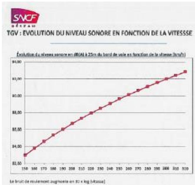
... (à 25m): variabilité de la mesure jusqu'à 10dB e
